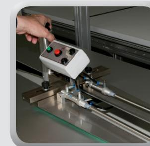
E' possibile avviare la macchina direttamente dalla pinza tensionamento.
