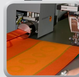
Su richiesta è disponibile un dispositivo di arrotolamento che avvolge i teli cuciti senza piegature. Il sistema comandi riconosce esattamente la posizione in cui deve essere accostato il telo successivo e blocca automaticamente la procedura di avvolgimento.
