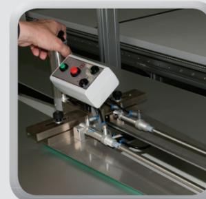
Start der Maschine ist direkt an der Spannklammer möglich.
