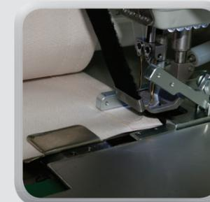
Sekundenschneller Wechsel der Führungsapparate. Auf Wunsch können spezielle Führungen, z.B. für Flauschband angefertigt werden.
