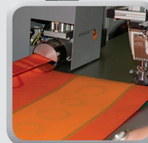
Optional ist ein Aufwickler erhältlich, welcher die genähten Stoffbahnen knickfrei aufwickelt. Dabei erkennt die Steuerung genau die Position, in welcher die nächste Stoffbahn angesetzt werden muss und stoppt automatisch den Wickelvorgang.
