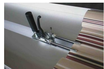
Stoffklammer zum Vorspannen Tightening device Dispositif tenseur matériau
