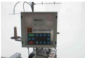
Steuereinheit mit Bedienungstasten Control unit with function keys Unité de contrôle avec touches
