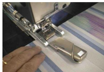
Führung für Überlappung und Saum Guide for hem and seam Guide pour assembler et ourler
